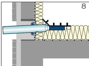
Das Auslaufrohr des Ablaufes bauseits in der Länge anpassen. Die Dichtung des Schiebeflansches und Auslaufrohr des Ablaufes mit LORO-X Gleitmittel versehen. Wärmedämmplatte im Bereich des Beckens des Ablaufes aussparen.
