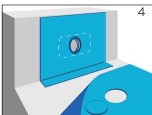
Werkseitig vormontierte Anschlussmanschette aus **Bitumen/EPDM Verbund** oder aus **Kunststoff** ausbreiten und auf Untergrund fixieren. Faltenbildungen sind zu vermeiden.
