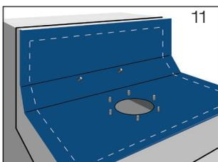
Zweite Lage der **Dachdichtungsbahn** über Ablauf ausrollen. Mit Locheisen Löcher  $\varnothing = 14$  mm für die Durchführung der Gewindebolzen in der Dachdichtungsbahn vorsehen. Der Losflansch kann als Schablone benutzt werden (Bild 11).
