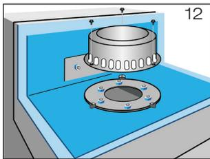
**12** Siebkorb (bei Freispiegelströmung) oder Haube (bei Druckströmung) mit beiliegenden Befestigungsschrauben mit Losflansch verschrauben (Bild 12). Beiliegende Schrauben mit Steck- oder Ringschlüssel SW 10 anziehen. Befestigung handfest bis max. 5 Nm.
