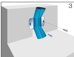
Schiebeflansch (mit zusammengerollter Anschlussmanschette) mittels Schlitzschraubenzieher befestigen (Bild 3).
