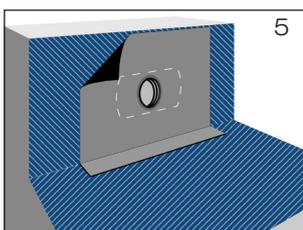
Bei Dampfsperrbahnen aus Bitumen sind Decke und Wand mit Bitumen-Voranstrich zu versehen (Bild 5).
