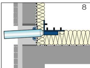
8 Das Auslaufrohr des Ablaufes bauseits in der Länge anpassen. Die Dichtung des Schiebeflansches und Auslaufrohr des Ablaufes mit LORO-X Gleitmittel versehen. Wärmedämmplatte im Bereich des Beckens des Ablaufes aussparen.
