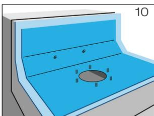
**Anschlussmanschette** bauseits aus vorhandener Bitumen-Dachdichtungsbahn, Größe: 700 mm x 1000 mm, zuschneiden (Bild 10). Mit Locheisen Löcher  $\varnothing = 14$  mm für die Durchführung der Gewindebolzen in der Anschlussmanschette vorsehen. Der Losflansch kann als Schablone benutzt werden.
