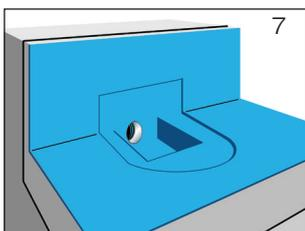
7 Wärmedämmplatten verlegen und im Bereich des Ablaufes ausreichend für die Ablaufmontage aussparen (Bild 7). Der Festflansch des Dachablaufs soll gemäß Flachdachrichtlinien oberflächenbündig in die Unterlage eingelassen werden.
