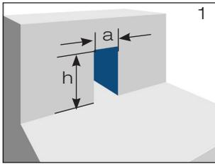
Attikadurchbruch nach Tabelle 1 erstellen (Bild 1). Damit die Dachfläche in der Bauphase entwässert werden kann, Durchbruch bis auf die Rohdecke ausführen.
