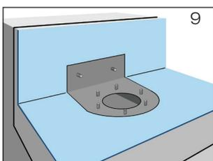
9 **Dachdichtungsbahn** über Attikaablauf ausrollen und im Bereich des Festflansches aussparen (Bild 9).
