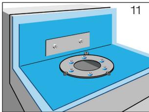
**11** Anschlussmanschette mit Losflansch und beiliegenden Sechskantflanschnuttern verklebten (Bild 11). Beiliegende Sechskantflanschnuttern mit Steck- oder Ringschlüssel SW 15, beginnend auf der Flanschseite unter  $90^\circ$ , anziehen. Danach die restlichen Sechskantflanschnuttern gegenüberliegend anziehen. Anzieh-Drehmoment: 30 Nm. **Nach der Fachregel für Abdichtungen (Flachdachrichtlinie Ausgabe Dezember 2016) müssen die Muttern der Flanschverbindungen 3x angezogen werden.**
