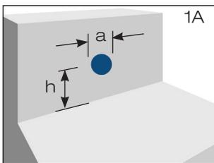
Attikakernbohrung nach Tabelle 2 erstellen (Bild 1A).
