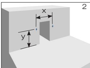
Bohrungen ø 10 mm für Schiebeflansch mit werkseitig vormontierter Anschlussmanschette zum Anschluss der Dampfsperre entsprechend der Vorgabe nach Tabelle 3 erstellen (Bild 2).
