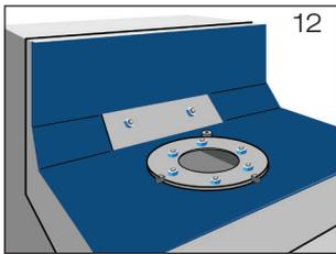
12 Dachdichtungsbahn mit Losflansch und beiliegenden Sechskantflanschmuttern verklebmen (Bild 12).
