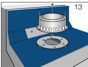
13 Siebkorb (bei Freispiegelströmung) oder Haube (bei Druckströmung) mit beiliegenden Befestigungsschrauben mit Losflansch verschrauben (Bild 13).
