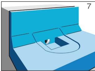
Wärmedämmplatten verlegen und im Bereich des Ablaufes ausreichend für die Ablaufmontage aussparen (Bild 7). Der Festflansch des Dachablaufs soll gemäß Flachdachrichtlinien oberflächenbündig in die Unterlage eingelassen werden.
