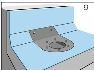
Erste Lage der **Dachdichtungsbahn** über Attikaablauf ausrollen und im Bereich des Festflansches aussparen (Bild 9).
